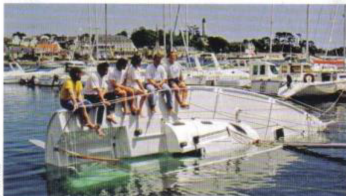
Le test très exigeant de stabilité à 90 degrés des bateaux «insubmersibles», ici un Pogo 8.50, n'est qu'un lointain souvenir. Mais la simple flottabilité ou incoabilité d'aujourd'hui reste une prudence louable.
