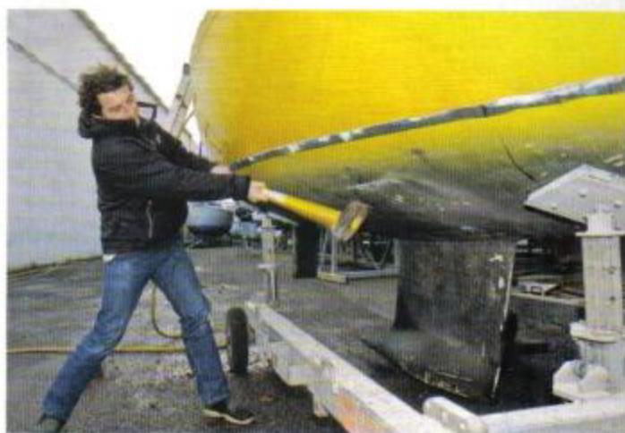
Rebonds. Un simple trait de scie ne suffit pas pour faciliter le percement de la coque. La masse rebondissant sur le polyester, il faudra quadriller l'endroit à la disqueuse.
